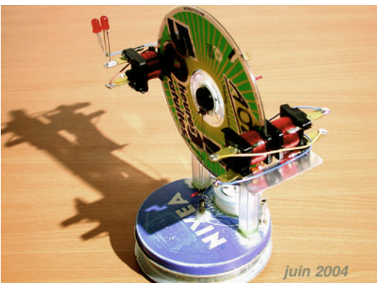
les 4 bobines sont montées en série afin d'obtenir une tension aussi élevée que possible
